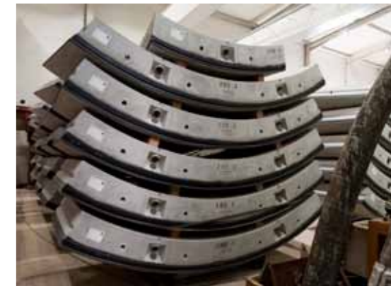
DEZE TUNNELSEGMENTEN VORMEN SAMEN ÉÉN TUNNELRING
